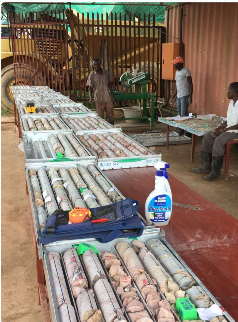
Рис. 4. Документация и первичная обработка керн разведочных скважин на объекте TNEL06075. Специалисты Metrox Gold Mining Limited проводят описание, разметку и фотодокументацию образцов. Апрель 2026 г.
